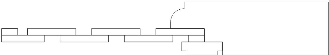
Gitterfüllung 6 mm, eingeleistet
