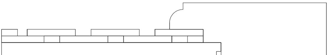
Gitterfüllung 6 mm mit Platte hinterlegt
